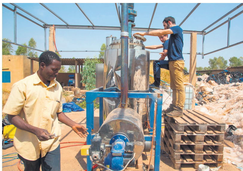
Avant même de commencer son voyage, l'équipe de Plastic Odyssey a testé son concept. Ci-dessus l'installation d'une machine pyrolyse au Burkina Faso.
