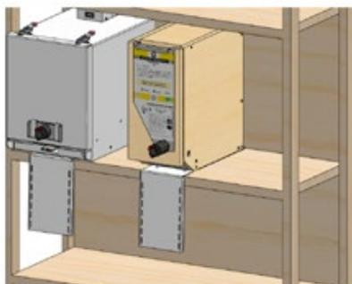
**e** Mettre en place la **partie 2** (Patte arrière) dans la **partie 1** (Encoche).
